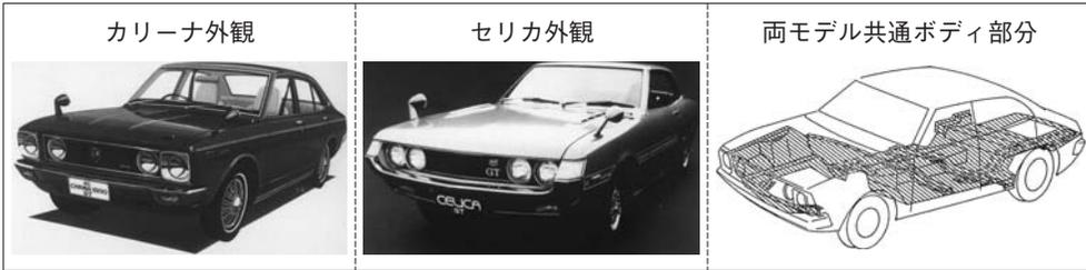
注) 右端の図で車線部分が共通ボディ部分。
