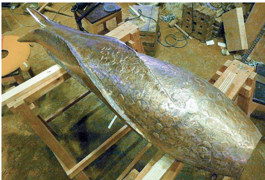
図29 湯道切断後の研磨工程
