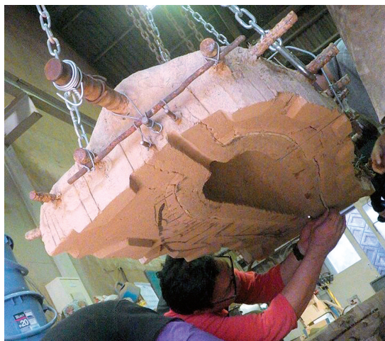
図13 中子吊り効果により完全に固定されている
