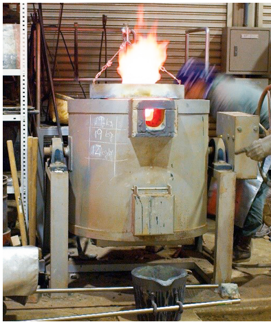
図24 可傾炉による金属熔解
