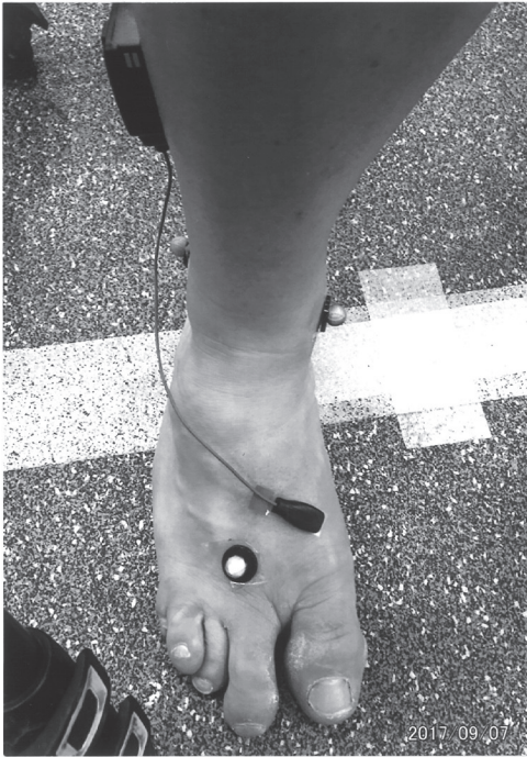
図2 Mattの左足上からみた写真 第2趾(手の人差し指に相当)は第1趾(親指)と同程度太く、長い。4趾も太い。両指間に隙間を認め、手の親指と人差し指のように対向して作用する。モーションキャプチャーのための直径4mmの反射マーカを足部の背側に、筋電図用のミニ電極を第2基節骨の内側の第一背側骨間筋上に貼付した。
