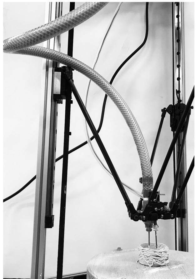
図20 ホースが動き変形することによる排出量への影響
