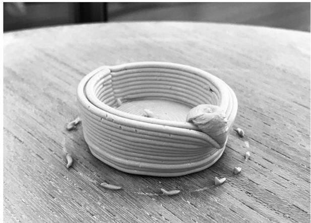
図18 粘度が高すぎてプリントを中断した造形物
