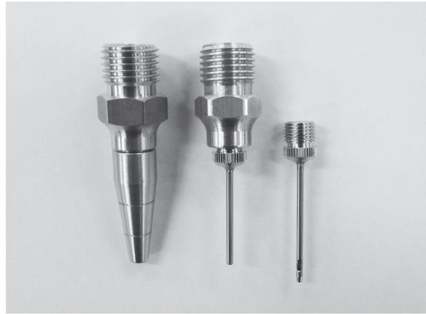
図2 3Dプリンタに流用したエアノズル
