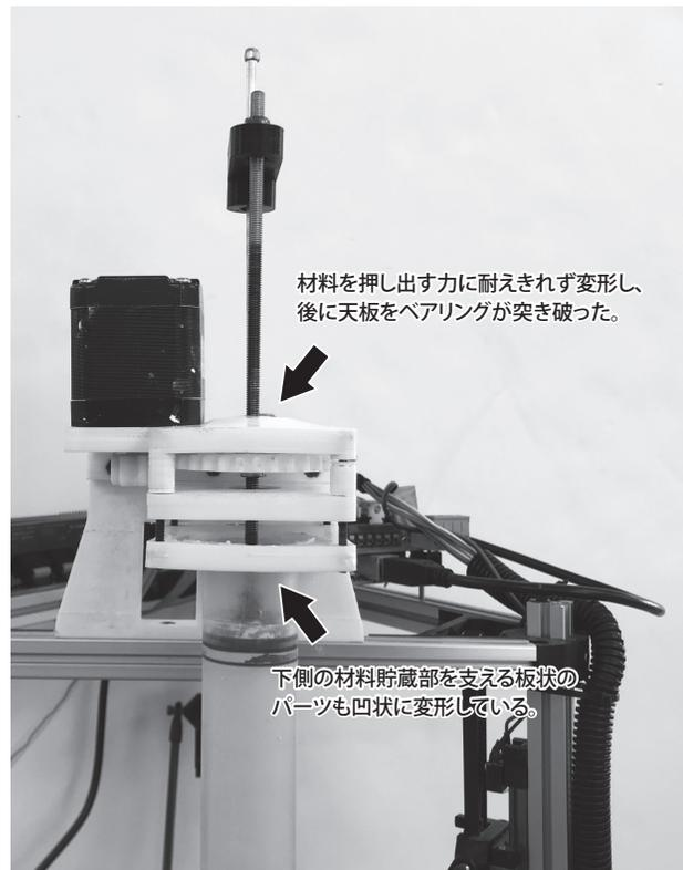
図17 排出圧力による部品の変形・破損
