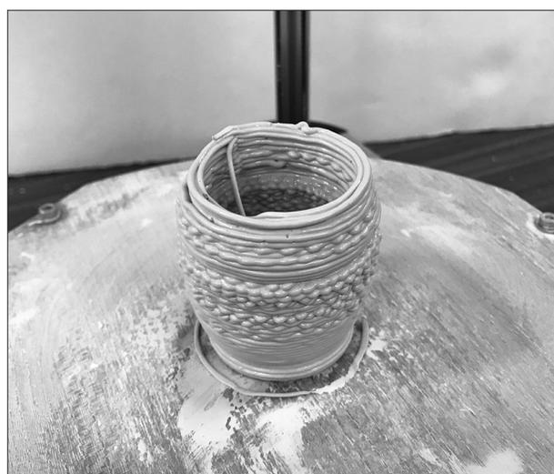
図16 「イ」1:1混合液を添加したテストプリントの結果
