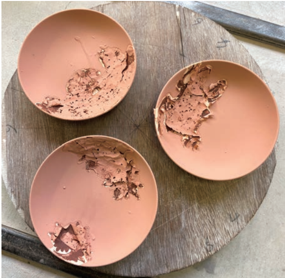
13) CH-H と CH-L を加えた染付釉の筆塗り施釉
