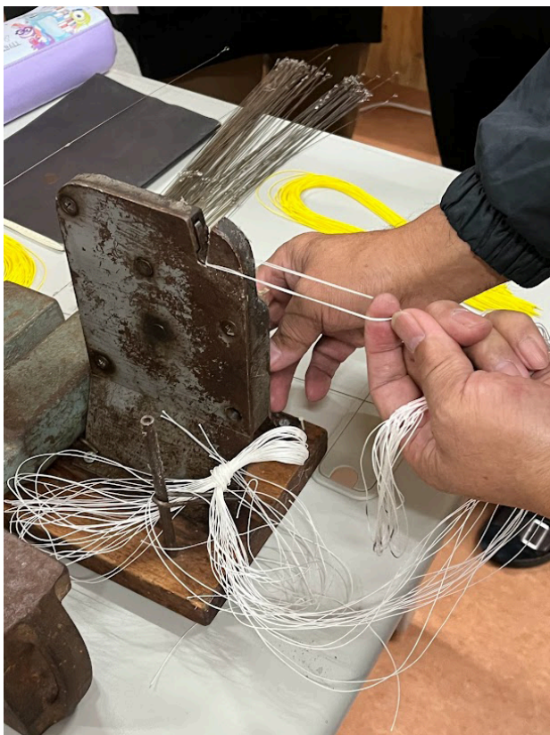
図6. 縫掛機を使って通じ糸に撚りをかける作業
