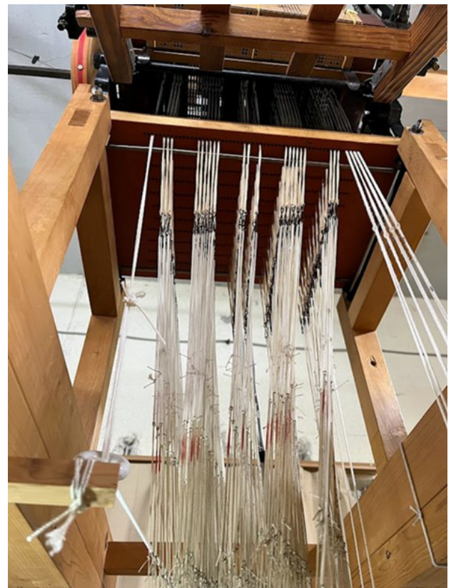
図4. 五献上の機仕掛け①(ジャカード機のとて針から下がった紐付きの竜頭(黒い金具)にそれぞれ通じ糸が計252本掛けられている)
