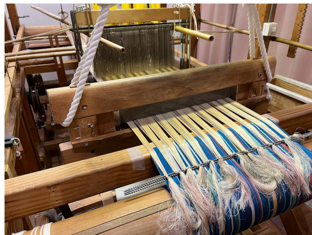
図 25. 箴通しが完了し織り付けを行った状態
