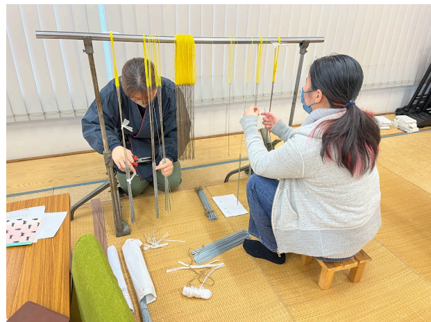
図8. 紋ワイヤーヘルドへの矢金の取り付け作業
