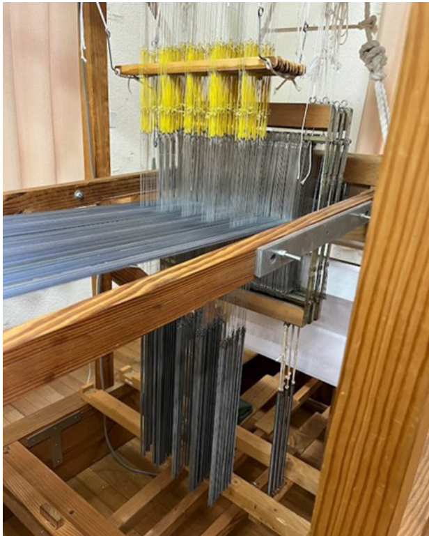
図5. 五献上の機仕掛け②（黄色いカタン糸と紋ワイヤーヘルド及び矢金が繋がったものが252本提げられている）
