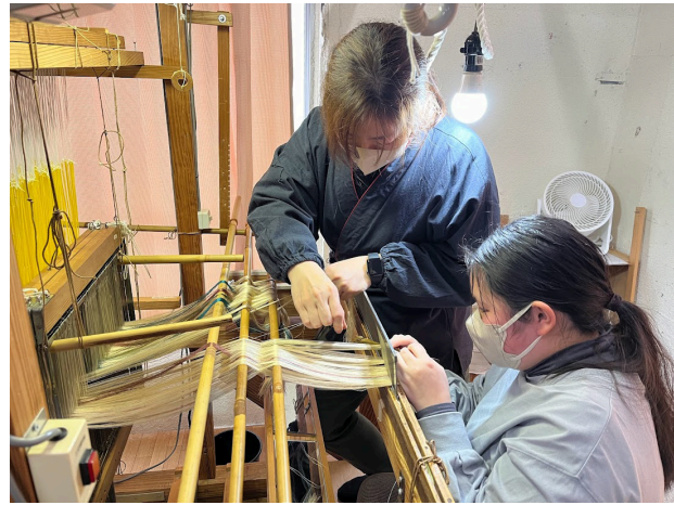
図 24. 箴通し：地糸・浮糸を順に綜統通しに掛け、箴に通していく様子
