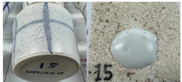
図18 本焼第2回のNo.15の気泡の痕跡
